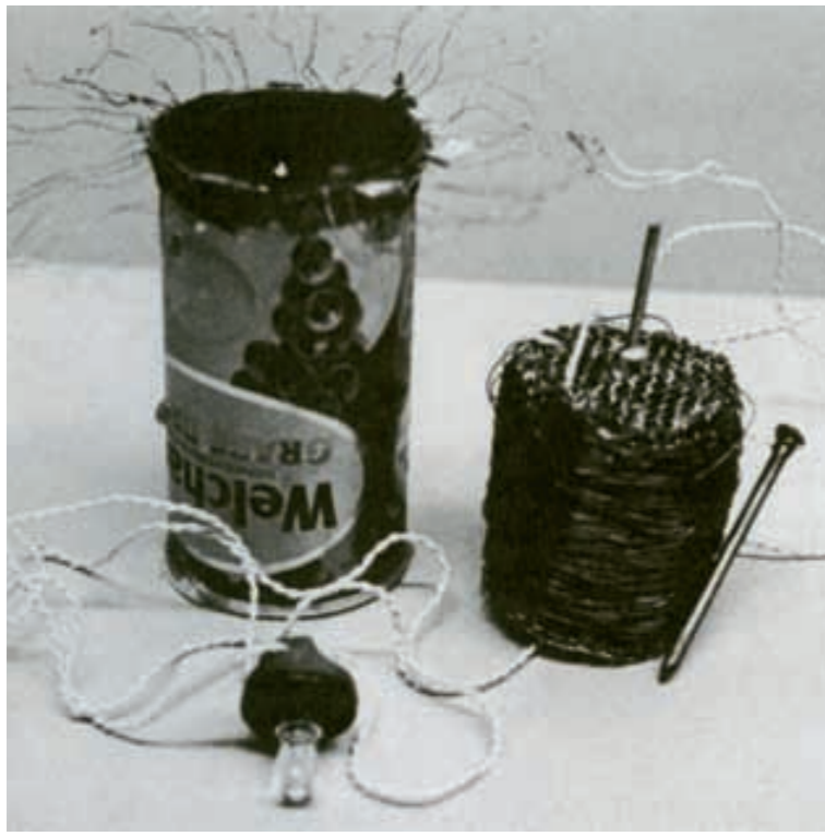
Tin Can Radio Bali, Indonésie 1965 « Un de mes premiers travaux pour l'Unesco à Bali a été le développement de la Tin Can Radio, une radio alimentée par une bougie, du bois, ou des excréments de vache séchés. Comme l'emballage pour ce dispositif était une boîte de jus de fruits usagée, j'ai décidé de ne pas la décorer du tout afin d'éviter d'imposer une esthétique européenne aux Indonésiens » 1 .
